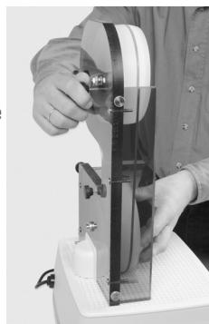
10) Fixez l'excentrique en-dessous de la bascule, sans exercer de pression. Remettez ensuite le cache ainsi que la table de travail et resserrez les vis.
