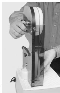
10) Senza esercitare alcuna pressione, fissare l'ecentrico al di sotto della barra..... Montare il riparo e il piano di lavoro nella loro posizione per poi stringere le viti di fissaggio.
