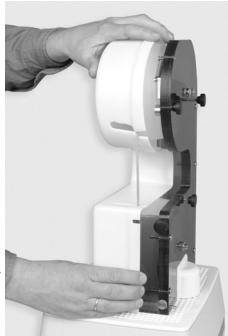
8) Posizionate la nuova lama diamantata nel mezzo della ruota inferiore. Spingete verso il basso la ruota superiore e mettete la lama su di essa allo stesso modo.
