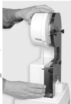
8) Colocar la nueva banda de la sierra centrada en la rueda inferior transportadora de banda. Presionar la rueda superior transportadora de banda abajo y poner aquí también la nueva banda de la sierra.
