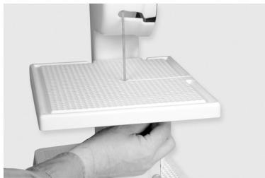
5) Du côté inférieur de la scie se trouve une tige d'environ 10 mm de long. Positionnez la scie de manière que cette tige se trouve dans la douille. Pour les meuleuses du type KRISTAL, le cône d' entraînement se trouve du côté de la plaque bleu transparente de la scie. Pour les meuleuses du type GLASTAR, GRYPHON et INLAND, le cône d' entraînement se trouve du côté opposé.
