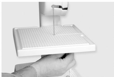
5) En el lado inferior de la sierra hay una espiga de 10mm. Hay que poner la sierra sobre la pulidora de manera que la espiga entre en el casquillo. Las pulidoras del tipo „Kristall“ tienen la rueda cónica en el lado de la placa lateral azul transparente. En las pulidoras de tipo „Glastar, Gryphon y Inland“ la rueda esta situada en el lado de enfrente.
