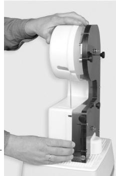
8) Legen Sie das neue Sägeband auf die untere Bandlaufrolle mittig auf. Drücken Sie dann die obere Bandlaufrolle runter und legen Sie auch dort das Sägeband auf.
