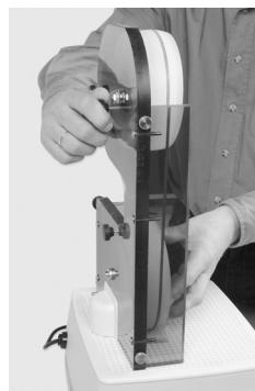
10) Stellen Sie den Excenter ohne Druck unterhalb der Wippe fest. Abschließend setzen Sie wieder die Haube und den Sägetisch auf und ziehen die Befestigungsschrauben an.
