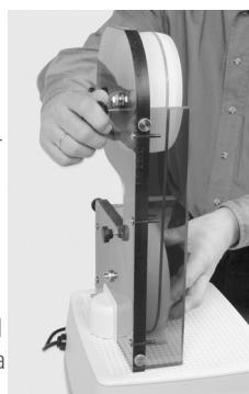
10) Fijar el excéntrico sin presión debajo del balancero. Después poner de nuevo la cubierta blanca y la mesa y apretar los tornillos de fijación.
