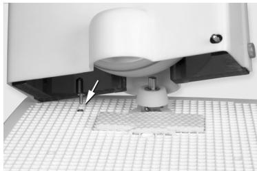
6) Schwenken Sie den Aufsatz jetzt an den Antriebskegel, um ihn dann mit dem Gummiband am seitlichen Stift und der Gitterplatte zu befestigen. Dadurch stellt sich ein konstanter Andruck am Antriebskegel ein. Nehmen Sie die Bandsäge durch Einschalten des Netzschalters der Schleifmaschine in Betrieb.
