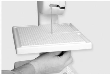
5) An der Unterseite des Sägeaufsatzes befindet sich ein 10 mm langer Stift. Die Bandsäge wird nun so auf die Schleifmaschine aufgesetzt, dass der Stift in der Hülse steckt.
